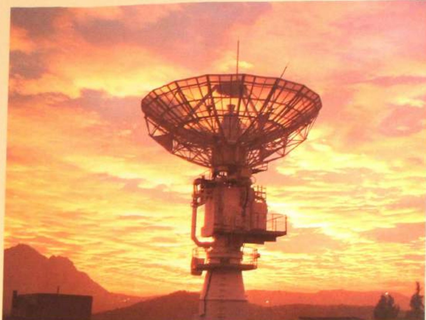
► Antena parabólica de 10 metros de diámetro de la agencia espacial japonesa instalada en Peldehue y operada desde Japón.
