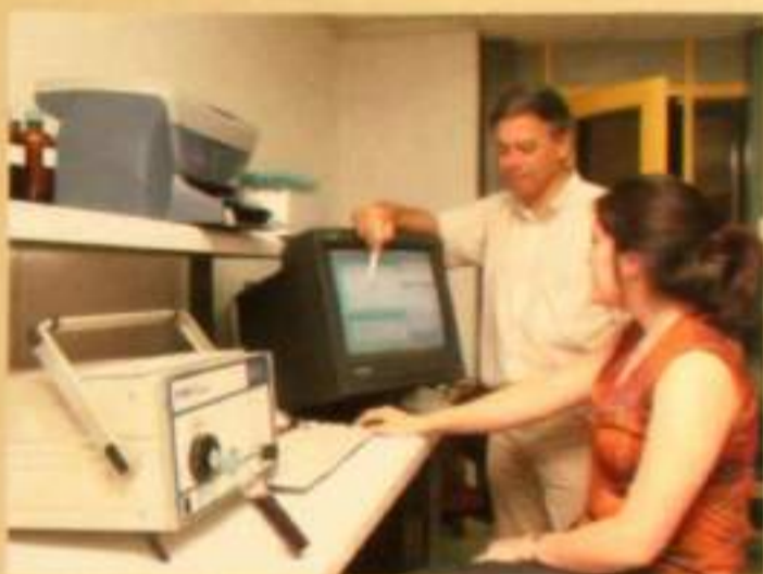
En el Laboratorio de Sistemas de Instrumentación, se desarrollan sistemas de Instrumentación Inteligente y aplicaciones de Sensores utilizando técnicas de extracción de características y clasificación. En la fotografía el Profesor Nicolás Beltrán, Director del Proyecto Fondecyt D01-1016, analiza una medición organoléptica realizada con una "nariz-electrónica" de una muestra de vino realizada por la ayudante del Proyecto.
