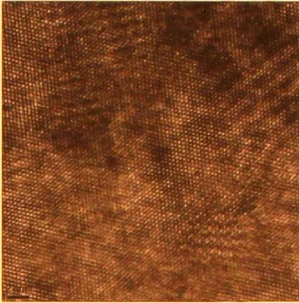
Plano (110) del Si, TEM de alta resolución. La marca corresponde a 2 nm. Los puntos corresponden a columnas de átomos de silicio.
