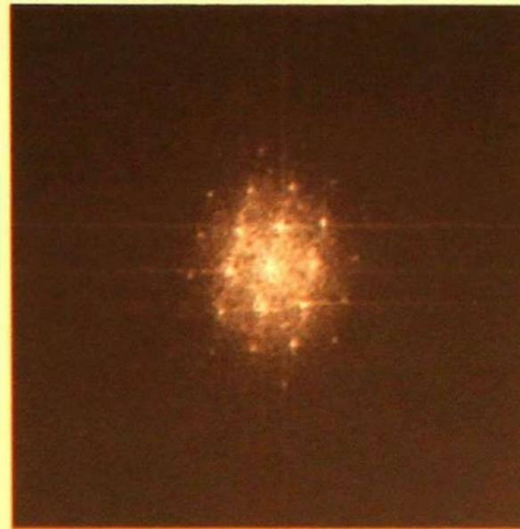
Figura de difracción de un cristal de Si.
