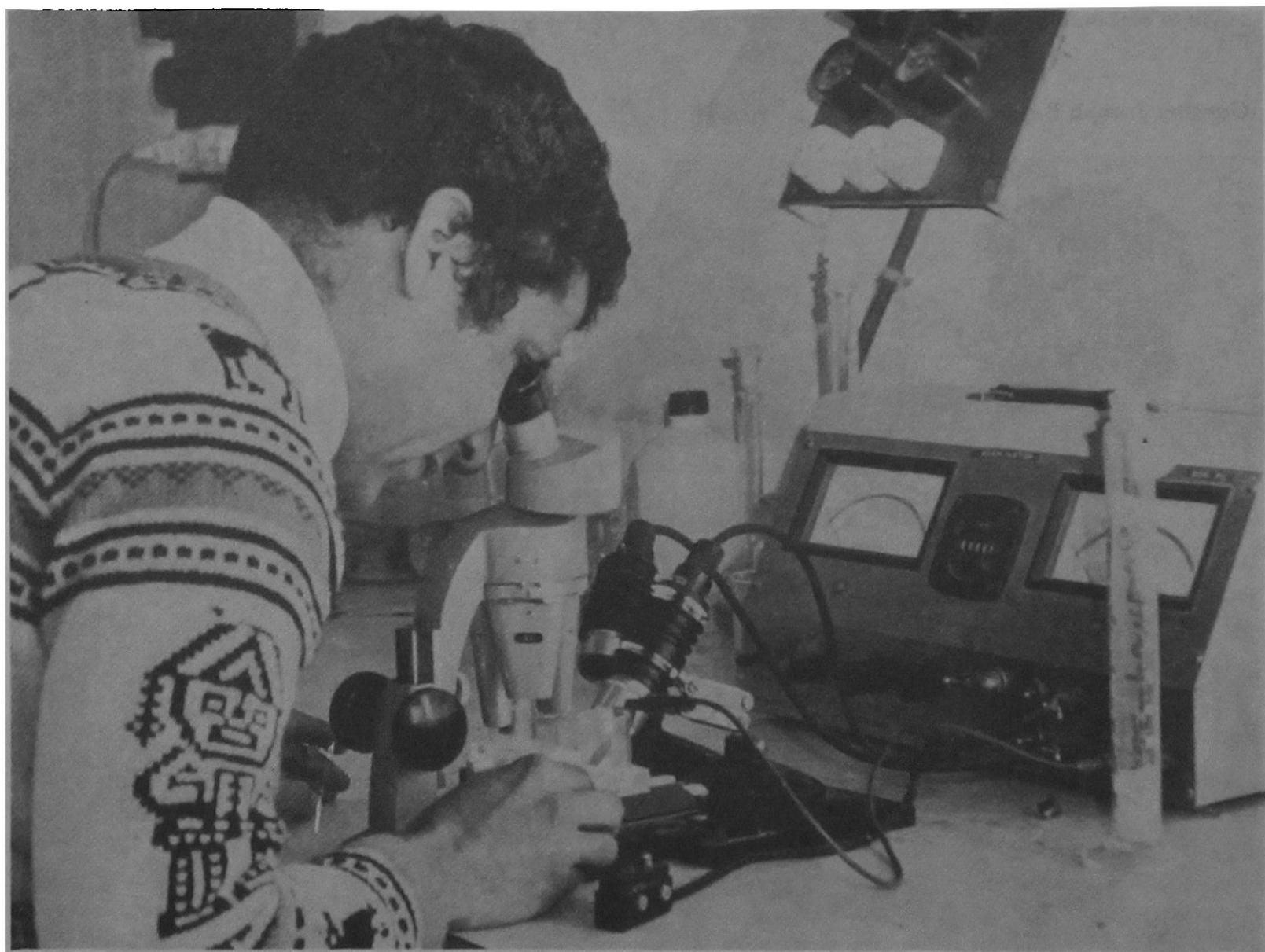
**Determinación de Carga Eléctrica superficial de Minerales en suspensión acuosa y en Zeta-Meter, Laboratorio Departamento de Minas.**
