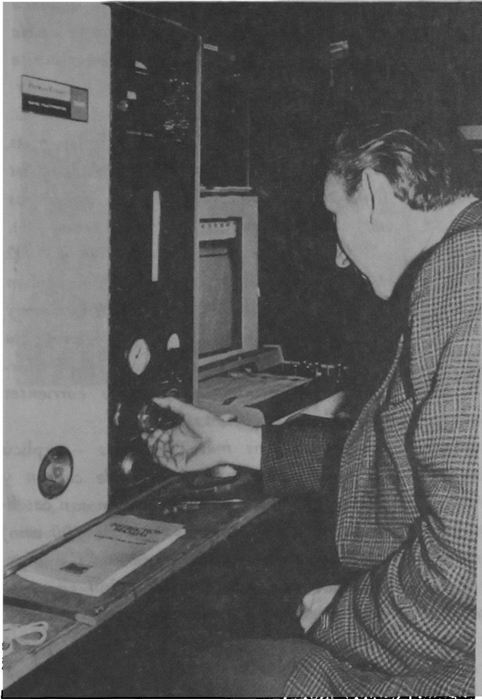
Cromatografo de Gases para analizar los productos de la gasificación del Carbón.
