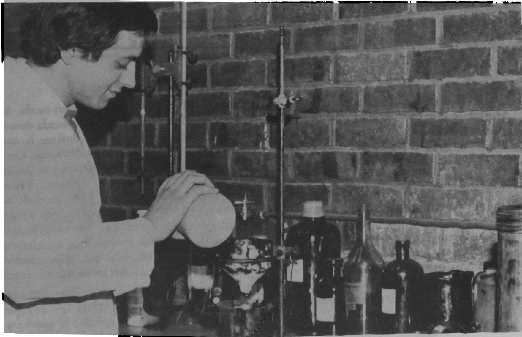
Carga de carbón en el reactor de licuefacción
