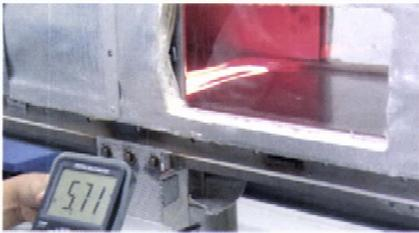
Las cortinas han sido sometidas a pruebas con una fuente térmica de hasta 1200°C.
