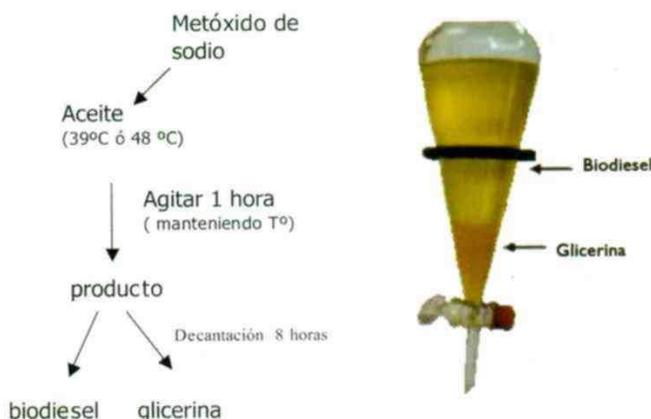
Figura 3. Esquema del proceso de transesterificación de aceites y foto de los productos obtenidos.
