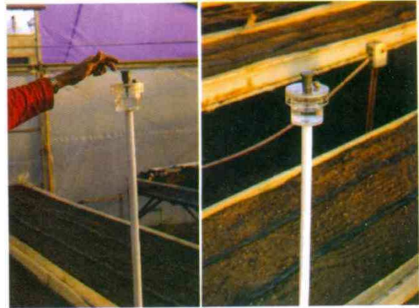
Evaporimetro Andersson sobre pedestal, a 1,5 m de altura.
