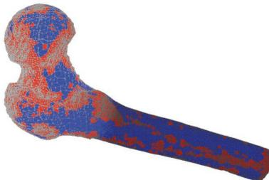
**Figura 5** • Discretización y visualización de la solución de elementos finitos del problema de la Figura 4, obtenida con el software desarrollado en el DCC por Eduardo Mercader.
