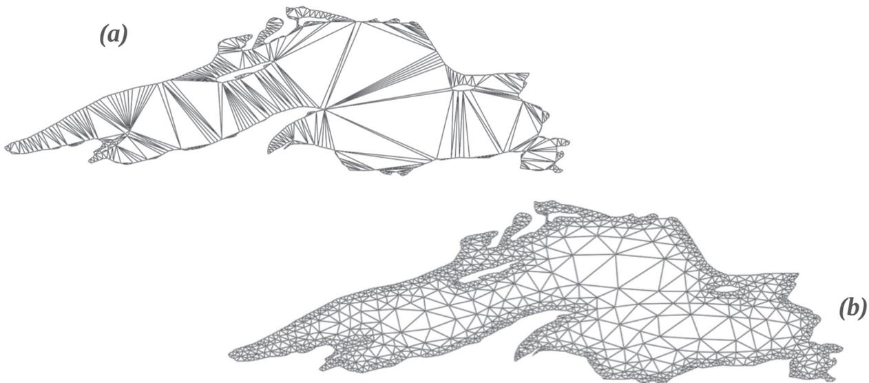
**Figura 2 •** Lago Superior: (a) Triangulación del borde del polígono. (b) Triangulación de buena calidad (ángulos mayores o iguales a  $30^\circ$ ), obtenida con algoritmo Lepp-Delaunay centroide (Rodríguez, Rivara).
