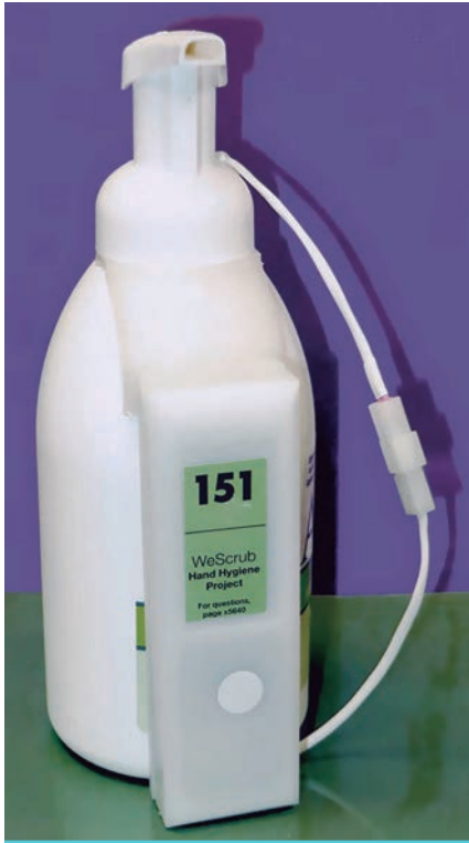
IMAGEN 5. DISPENSADOR DE JABÓN-ALCOHOL PARA LA HIGIENE DE MANOS, EQUIPADO CON UN SENSOR PARA DETECTAR QUIÉN LO ACTIVO Y CUÁNDO LO HIZO.
