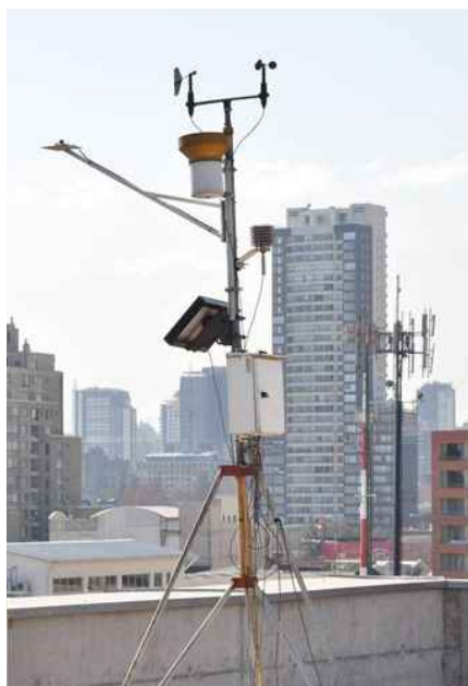
FIGURA 8. ESTACIÓN METEOROLÓGICA AUTOMÁTICA DEL DEPARTAMENTO DE GEOFÍSICA DE LA FACULTAD DE CIENCIAS FÍSICAS Y MATEMÁTICAS (FCFM) DE LA UNIVERSIDAD DE CHILE. FUENTE: DEPARTAMENTO DE GEOFÍSICA, FCFM, DE LA UNIVERSIDAD DE CHILE.
