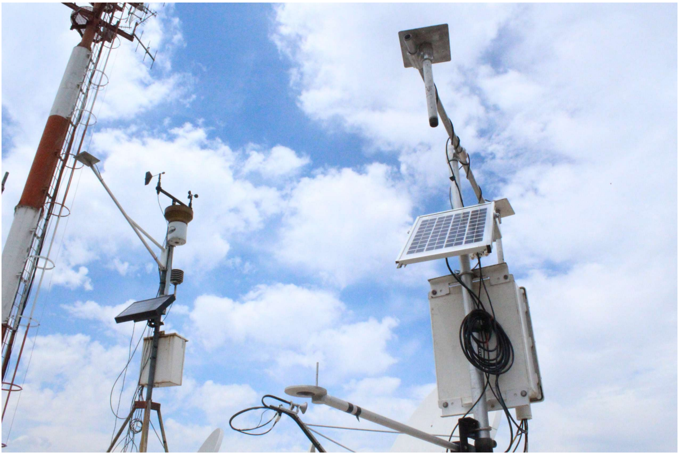
FIGURA 1. VISTA DE DOS ESTACIONES METEOROLÓGICAS AUTOMÁTICAS (EMAs) SOBRE LA TERRAZA DEL DEPARTAMENTO DE GEOFÍSICA.
