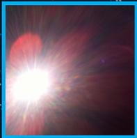
Vista del Sol en distintos puntos de la órbita. La elongación del sol junto al tiempo de exposición nos da información del movimiento del satélite.
