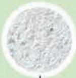
La mayor parte del techo está recubierto con una baldosa microvibrada de color blanco que reduce el efecto isla de calor, es decir, no acumula calor para luego irradiarlo.
