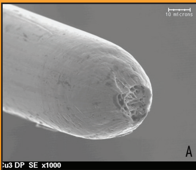
(A) Micrografía (microscopía electrónica de barrido) de la superficie de ruptura por tracción de un alambre fino de Cobre de 0.03 mm de diámetro.
