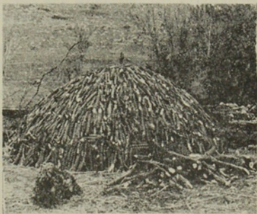
Fig 4 Horno de madera de espino ( Acacia caven MOL), en construcción, faltando la cubierta de barro (Laguna de Batuco)
