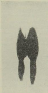
Fig. 6. Cromatograma de papel mostrando manchas de magnesio ( $R_f$  0,14) y más arriba de sodio ( $R_f$  0,57) de las hojas sanas (derecha) y enfermas (izquierda).
