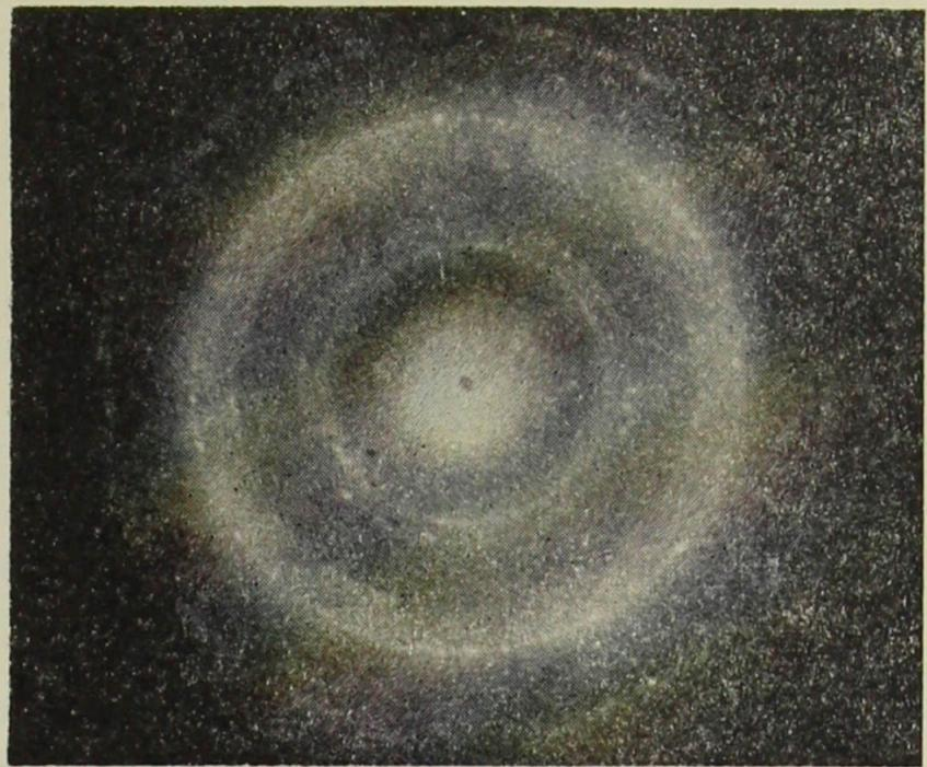
10 Trozos de esmalte de una muestra molida. Observada por transparencia en el microscopio electrónico, a la derecha el diagrama de difracción de las partículas. Nótese la disposición de los puntos de difracción. 30.000 ×
