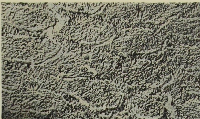
2 Prismas cortados oblicuamente. Réplica al microscopio electrónico de una muestra pulida y atacada. Compárese el poder separador con la figura anterior. 3.700 ×
