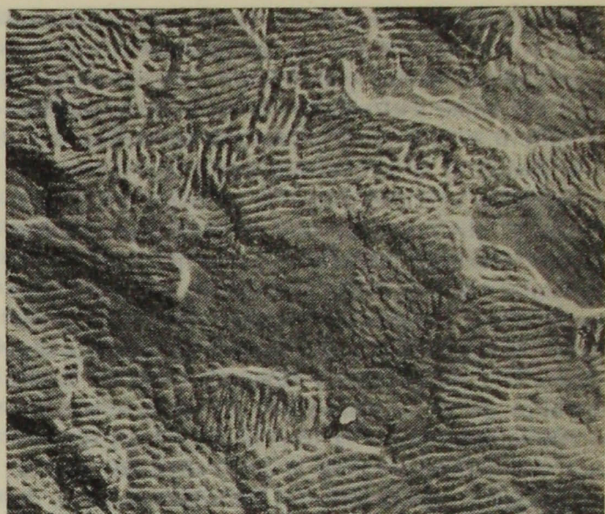
Aluminio deformado 40% por impacto. Pulido electrolíticamente y atacado. 8.400 X Según Kittl y Rodríguez. J. Inst. Metals, 91 (1962-63), 284
