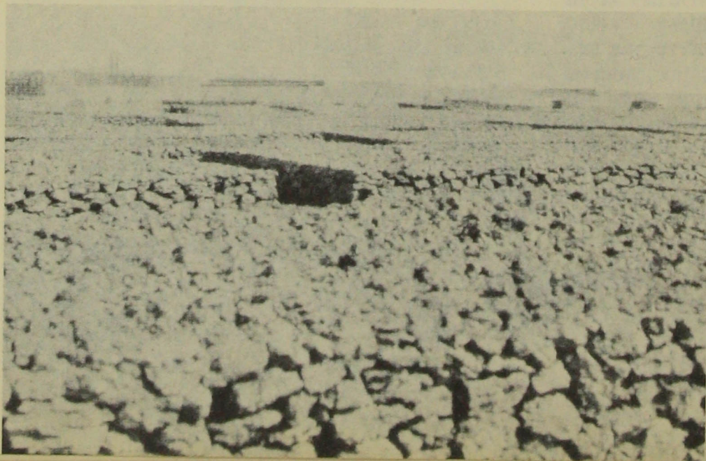
Pilas cubicadas de "caliche", depositadas frente a la Oficina
