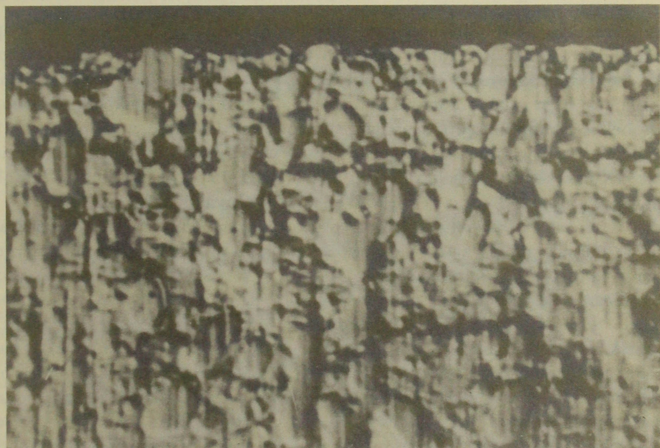
Figura 1. Fotografías de contraste de interferencia (2700 x de aumento) que muestran la corrosión por extractos de madera cerca del filo de un cortador de acero pulido (2% carbono, 12% cromo). La fotografía superior muestra el estado original y la fotografía debajo muestra los carburos levantados sobre la profundamente carcomida matriz martensítica. Esto sucedió al cortar una delgada astilla de 15 centímetros de largo de madera de pino ( Pinus radiata ) saturada de agua. Las fotografías fueron amablemente proporcionadas por W. M. McKenzie de la División de Productos Forestales, Commonwealth Scientific and Industrial Research Organization, Melbourne, Australia.
