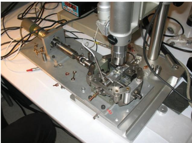
Máquina de microtracción.
