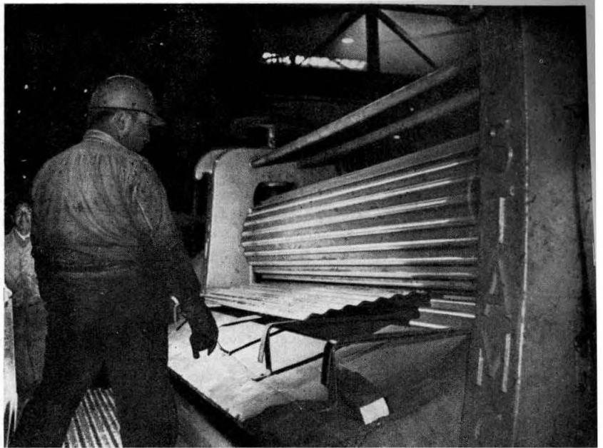
UNA VEZ CINCADA LA PLANCHA SE ACANALA EN ESTA MAQUINA.
