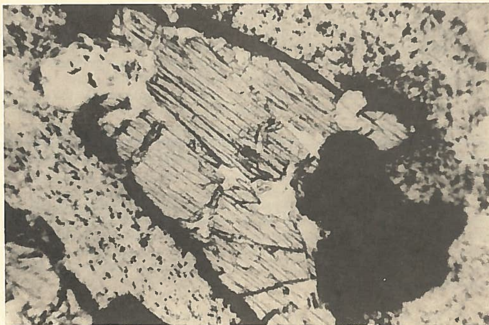
Fig. 5 Fenocristal de clinopiroxenas con borde de reacción opacítico. (Muestra M-63) Nícoles paralelos x 100.
